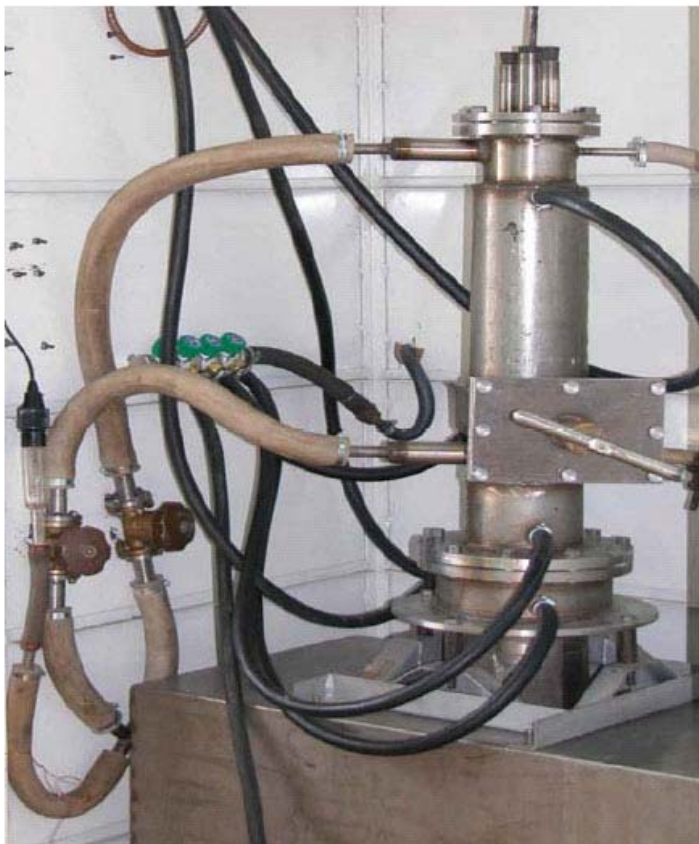
Пилотная установка для получения танталовых порошков
